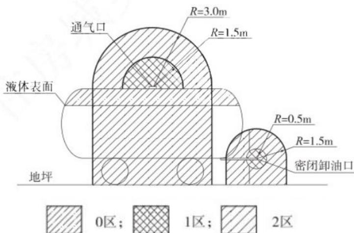
图 3.5-2 汽油储油罐车爆炸危险区域划分
