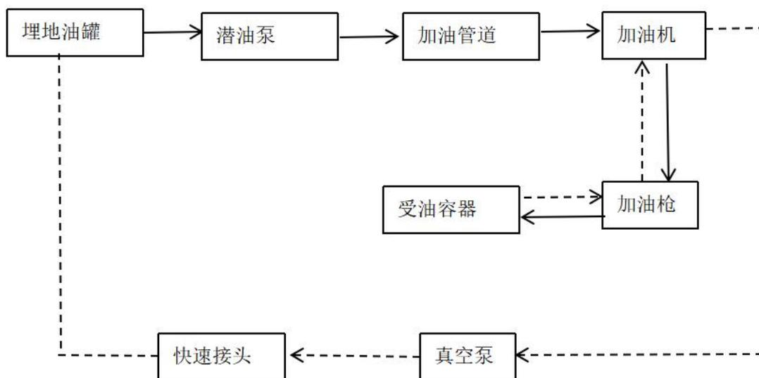
图 2.6-3 汽油加油工艺框图
