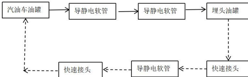
图 2.6-1 汽油卸油工艺框图
