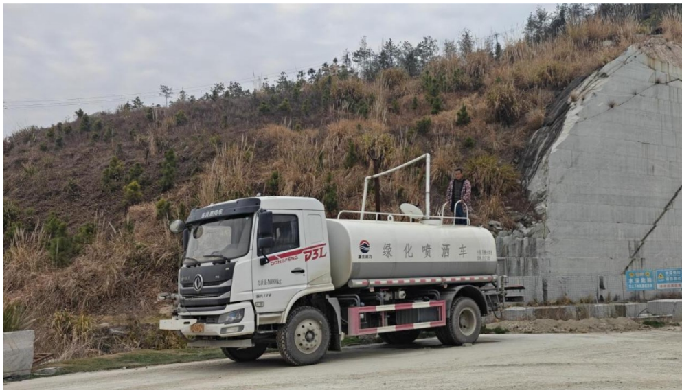
图 2.5-5 矿区防尘设施
